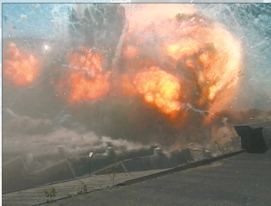
Figuur 1 Frames uit de videobeelden van de laatste explosie. De beelden rechts van boven naar beneden geven de sequentie weer. De uitvergroting is van een moment vlak voor het onderste beeld rechtsonder. Op de daken op de voorgrond is door opwolkende stofdeeltjes de turbulentie te zien die het gevolg is van het passeren van de schokgolf.
